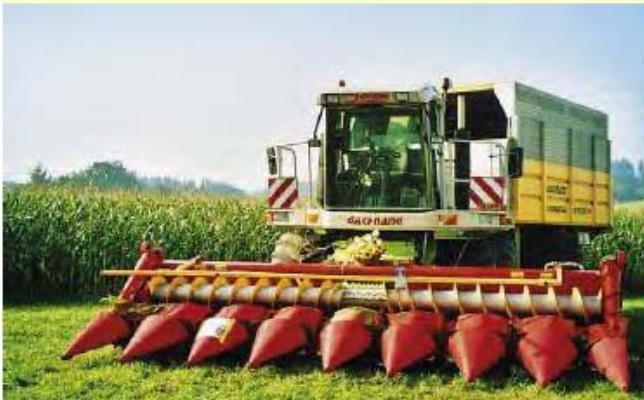
Der von Hans Gachnang selber gebaute Weichhäcker mit Spezialgäben mit aufblasbaren Bunkern.
