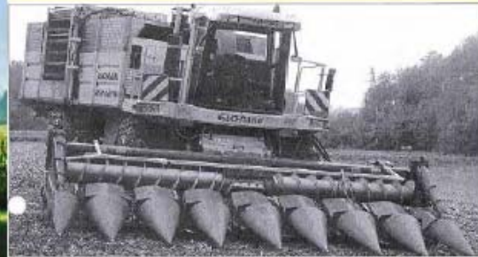
Der von Hans Gachnang selber gebaute Weichhäcker mit Spezialgäben mit aufblasbaren Bunkern.
